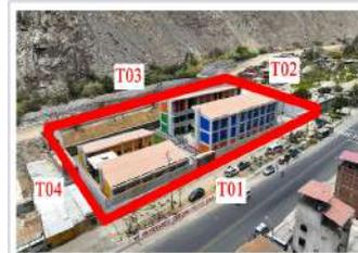
**TRAMO:** Es una línea recta que une dos vértices de la poligonal perimétrica.
